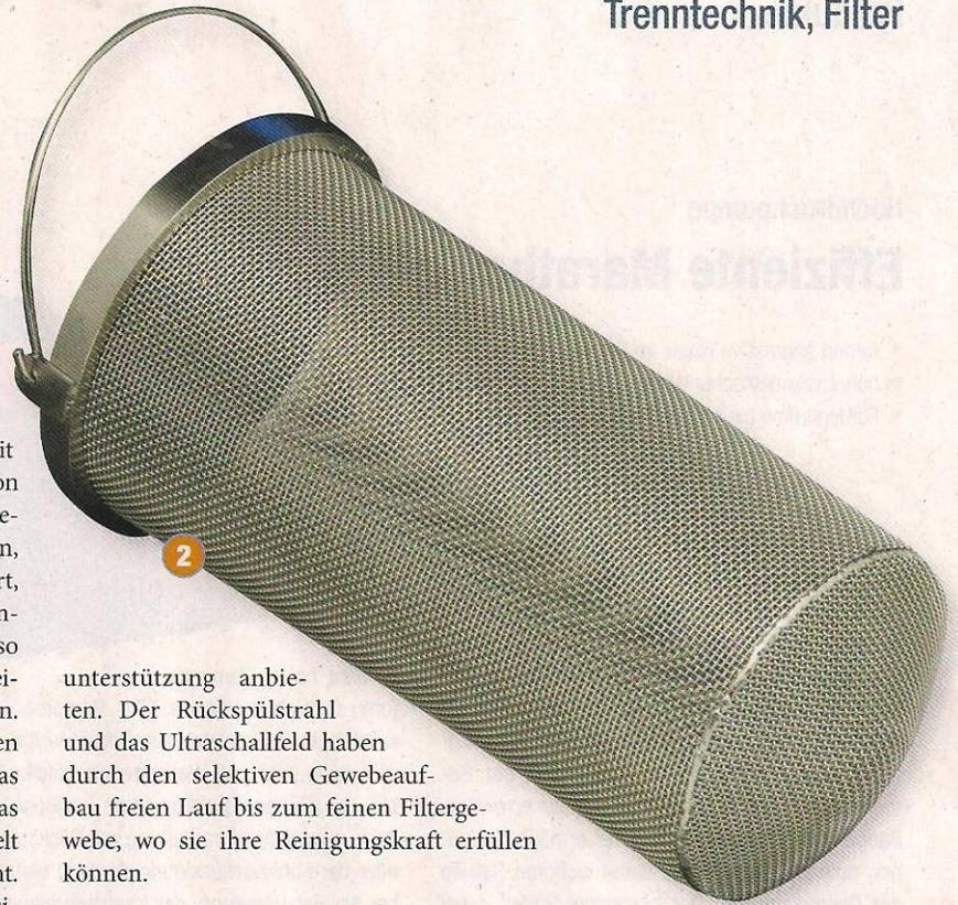
leert werden soll. Das Gehäuse wird geöffnet, der Korb entnommen und entleert. Gegebenenfalls wird er durch einen drucklosen Flüssigkeitsstrom rückgespült. Einem starken Flüssigkeitsstrahl hält die Auskleidung nicht stand.
