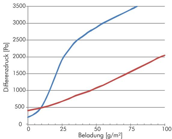
Druckverlauf bei unterschiedlichen Beladungen mit Teststaub
