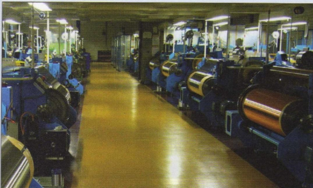
Hightech Webmaschinen, die eine Maschenweite von 5µm erzeugen können
