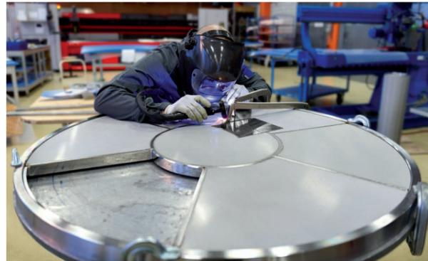
Geschweißte Verbundgeweberonden bis zu 3 Meter Durchmesser
