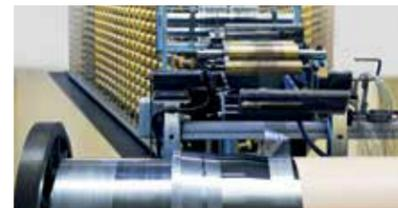
ziehen. Die hochfeinen Drähte werden auf modernsten Webmaschinen – es handelt sich ausnahmslos um Eigenentwicklungen – unter Reinraumkonditionen in einem klimatisierten Spezialgebäude verwoben. Für höchste Anforderungen können die Feingewebe auf einer eigens dafür entwickelten Reinigungsanlage gewaschen und anschliessend elektronisch kontrolliert werden. Die durchgängige Qualitätssicherung und Prozesssicherheit garantiert erstklassige Werte bei 100%-iger Reproduzierbarkeit beim Endprodukt.
