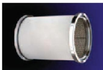
In der Filtration werden durchflussoptimierte Verbundgewebe unter anderem für Schutzfilter, die für empfindliche hydraulische Steuerelemente benötigt werden, eingesetzt. Durch Stanzen oder Laserschneiden der Gewebe, sind alle denkbaren Formen realisierbar. Die Teile können durch Verpressen des Randbereiches ohne die sonst üblichen Blecheinfasungen preisgünstig hergestellt werden. Üblicherweise werden hier Filterfeinheiten von 20 bis 60 Mikrometern verwendet.
